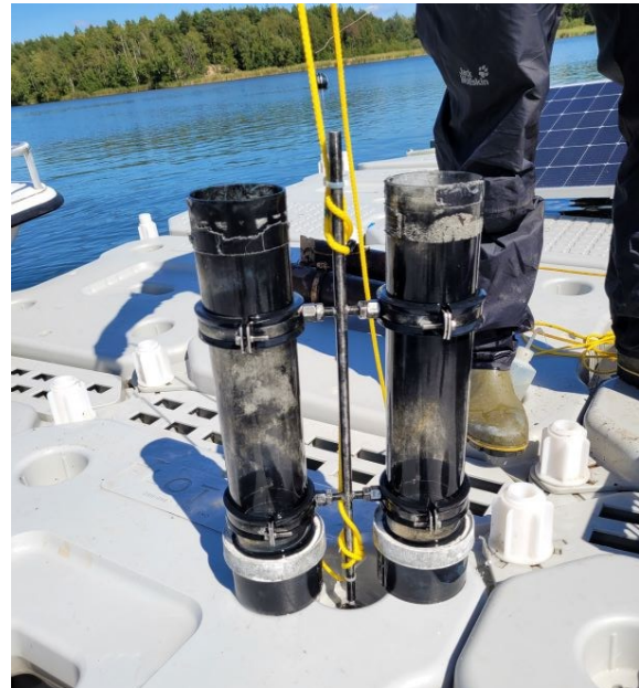
Abb. 51: Aus dem Hypolimnion geborgene Sedimentationsfalle (FPV-Anlage B, 26.08.2025)
