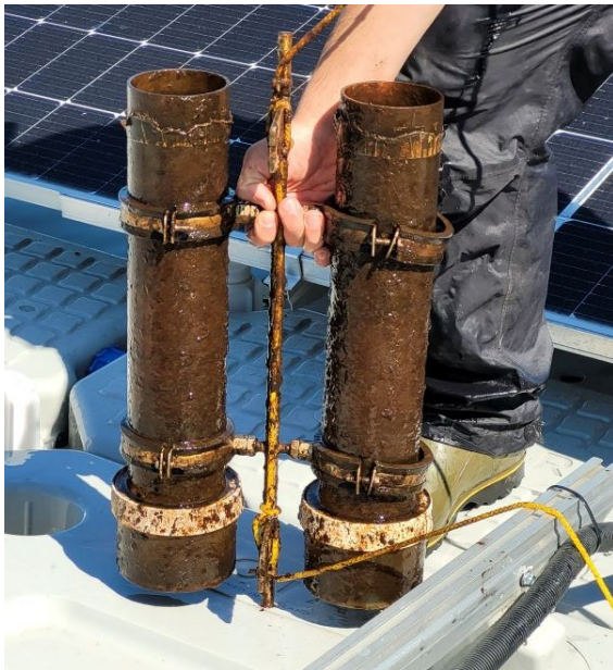
Abb. 50: Aus dem Epilimnion geborgene Sedimentationsfalle (FPV-Anlage B, 26.08.2025)
