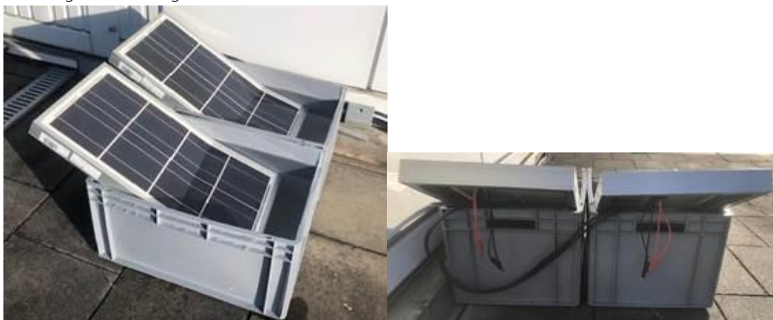
Abbildung 11: Leaching-Test am FHG ISE Ansicht seitlich (links) und rückwärtig (rechts).
