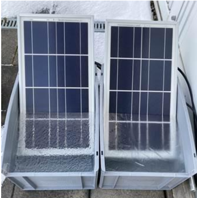
Abbildung 12: Leaching-Test am FHG ISE, Aufnahme vom 11.01.2024 DI-Wasserbecken (links) NaCl-Becken (rechts).
