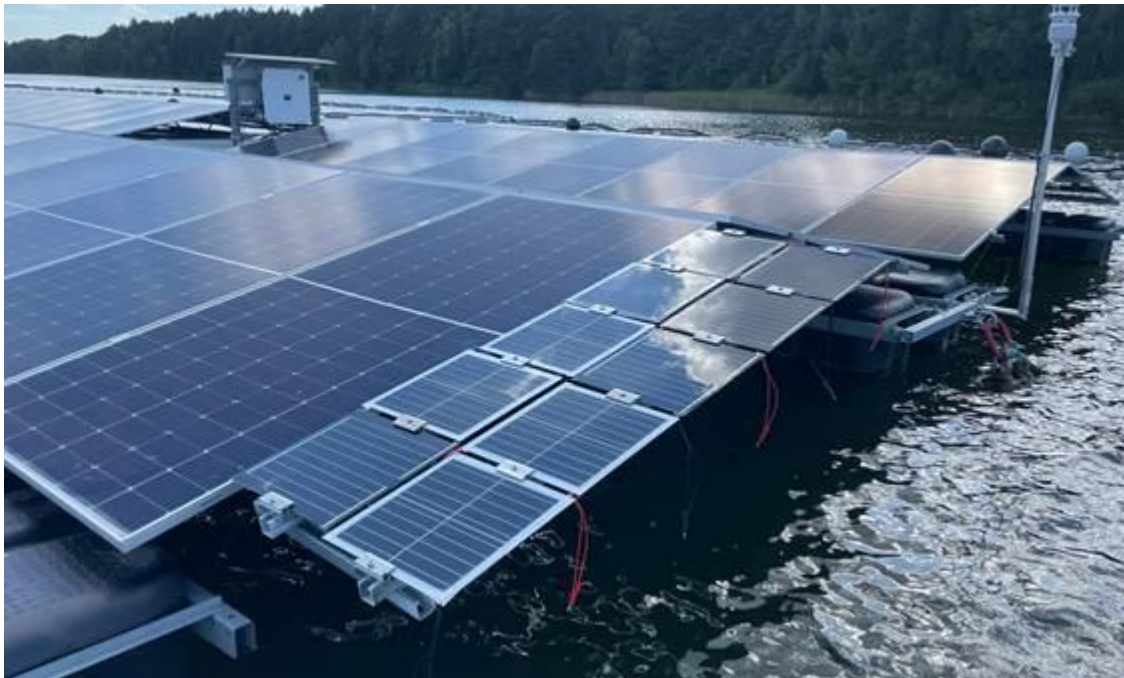
Abbildung 26: Exposition der Mini-Module in Lohsa auf dem Zimmermann-Demonstrator seit 28.08.2025.
