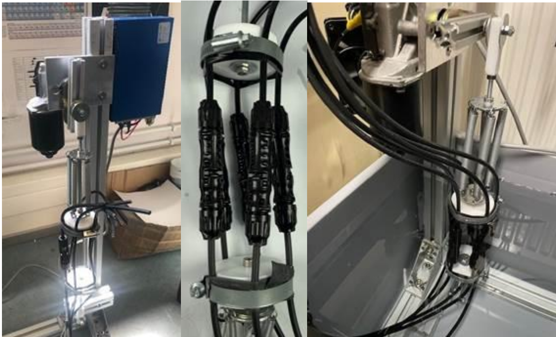
Abbildung 18: Vorrichtung für den mechanische Belastungstest von Steckern und Kabeln (links). Prüfmusterhalter für 5 Steckerpaare (Mitte) Testapparatur im Prüflauf (rechts) (FHG ISE).
