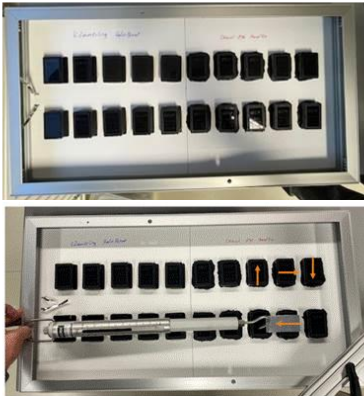
Abbildung 10: Prüfmuster für Anschlussdosen mit zwei verschiedenen Klebematerialien (oben) und Haftprüfung gem. IEC 61215-2:2021 (unten).
